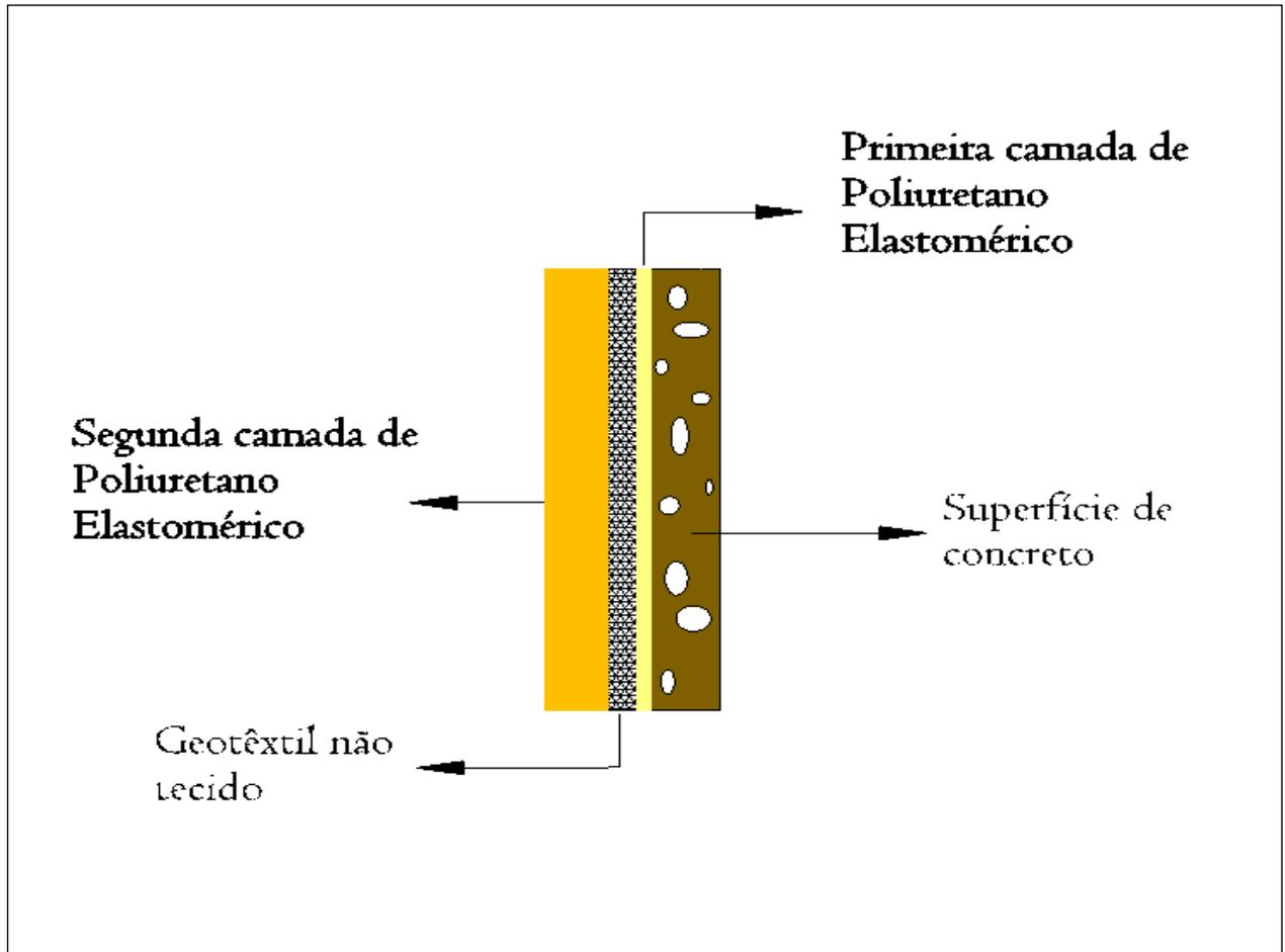
Figura 1 – Perfil exigido para o revestimento impermeabilizante
